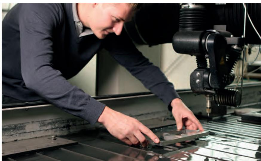
Tobias Trumpp **beim Einrichten** an der Wasserstrahl-anlage.
