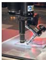
Mit dem 60-Grad-Winkelkopf können auch komplexe Geometrien erzeugt werden. Bilder: Innomax
