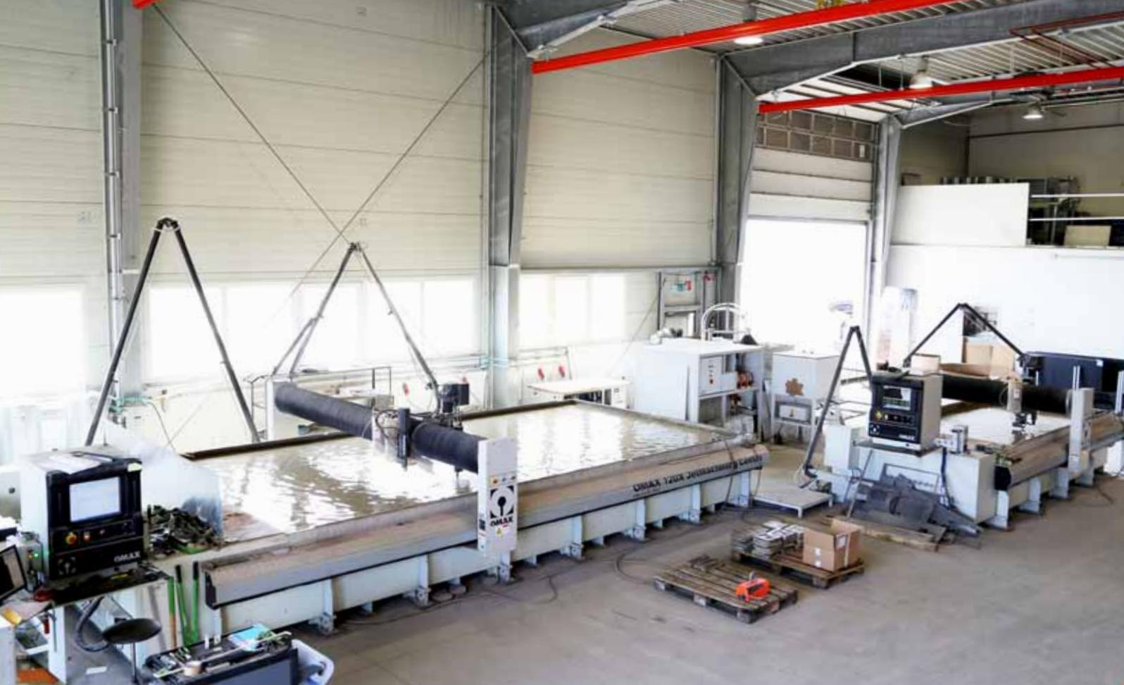
**M-Tron ist mit zwei Wasserstrahlschneidanlagen von OMAX im Zuschnitt bestens aufgestellt.** Die Hochdruckleitungen beider Anlagen werden durch Scherensysteme und nicht durch Peitschen geführt. Dadurch werden Schwingungen am Schneidkopf verhindert, was sich wiederum positiv auf die Genauigkeit auswirkt.
