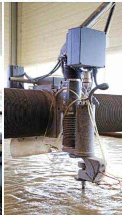
**oben** Das OMAX 120X JetMachining Center ist mit einem 3D-Winkelschneidkopf sowie einer zusätzlichen Bohreinheit ausgestattet und verfügt über einen Verfahrensweg von 6.000 x 3.000 mm.
