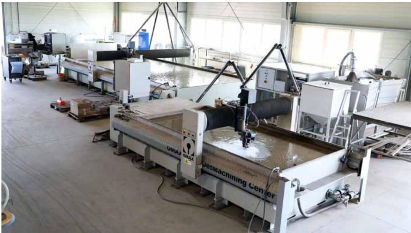
**Das OMAX 60120 JetMachining Center** im Vordergrund verfügt über den innovativen Präzisionsschneidkopf Tilt-A-Jet und 3.000 x 1.500 mm Verfahrweg.
