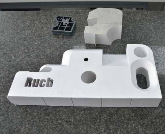
Musterteile bei Ruch für 3D-Schnitte in Aluminium
