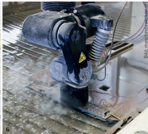
6 Die Wasserstrahlschneidanlage schafft prozesssicher eine Genauigkeit von \pm 0,05 Millimeter.
